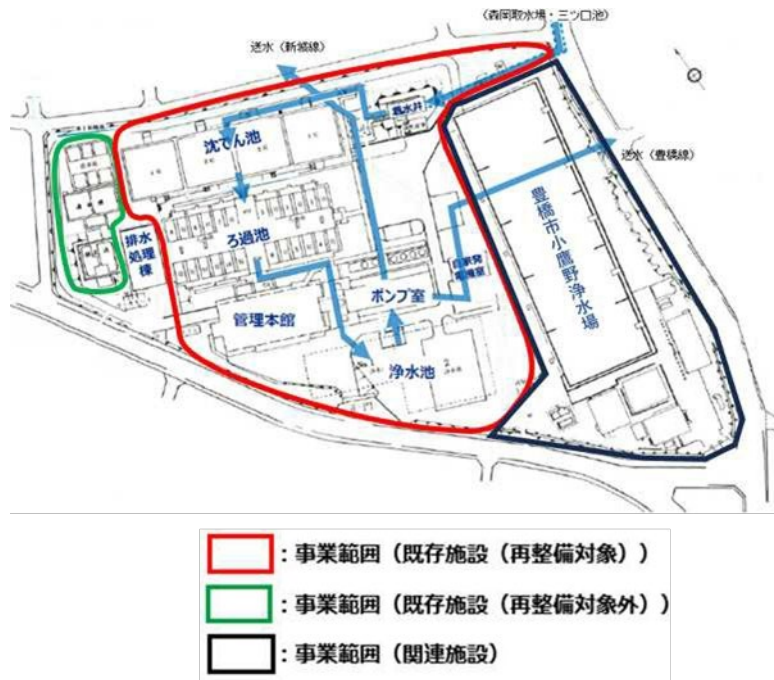
図表-1.1.2 対象施設（豊橋浄水場）
